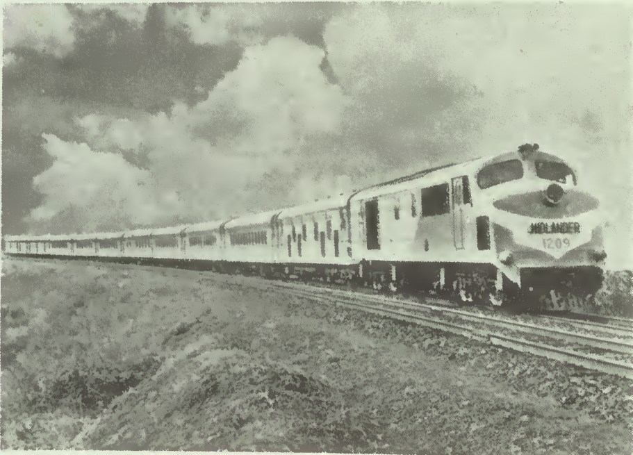
Uma das 10 locomotivas diesel «English Electric» 1500 H. P., tipo «Midlanders», em serviço na Austrália
