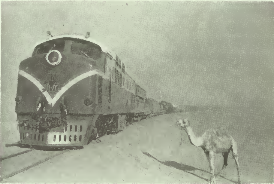
Eis uma poderosa «loco» diesel inglesa, de 1850 H. P., tipo CC, expressamente construída para os Caminhos de Ferro do Sudão, atravessando uma região desértica em Atbara
