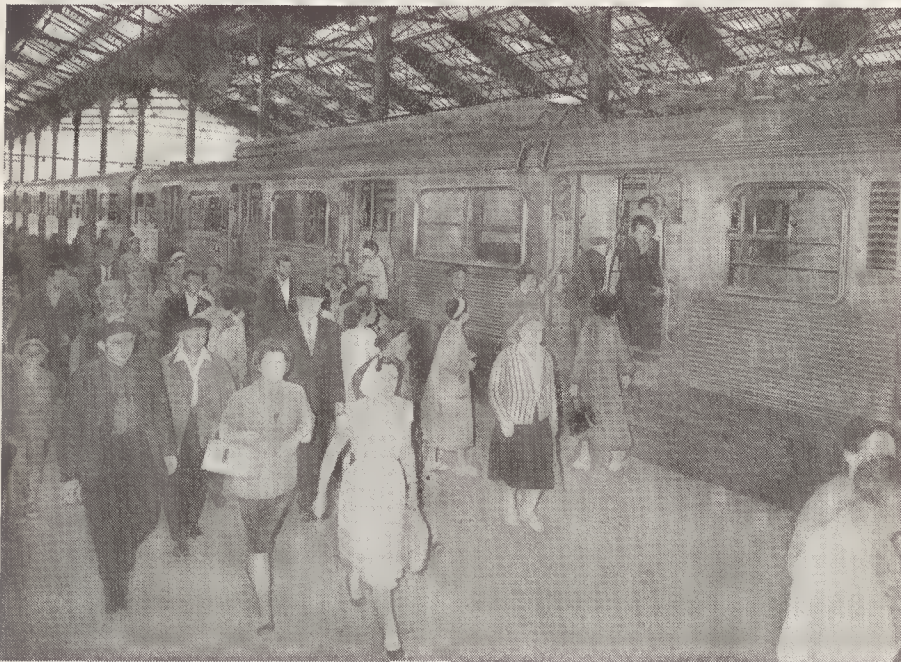
O mais moderno material das linhas suburbanas de Paris: unidades automotoras eléctricas de aço inoxidável dos arredores (Sudeste). A fotografia mostra o desembarque dos passageiros na estação de Lyon, em Paris
