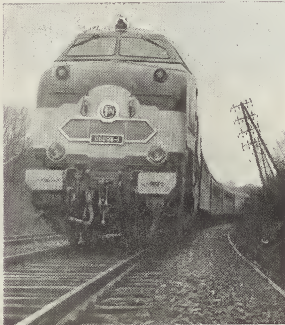
A dieselização da rede francesa está em plena execução. A S. N. C. F. tem-na feito por conjuntos de linhas de características semelhantes, o que muito facilita a rotação das locomotivas. Estas têm potência variável conforme o serviço a que se destinam: as de menor potência são utilizadas em manobras e nas linhas secundárias e as de maior, como a da fotografia, nas linhas mais importantes
