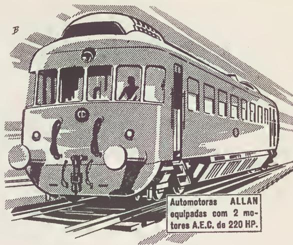
Automotoras ALLAN equipadas com 2 motores A.E.C. de 220 HP.
