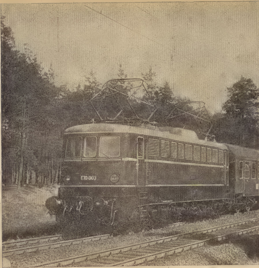
Locomotiva eléctrica B'o B'o do tipo previsto para a C. P.
