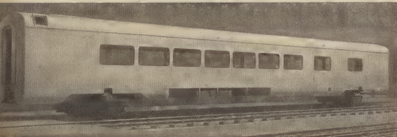
Caixa exposta interior e exteriormente ao jacto de areia, de uma carruagem-restaurante mexicana, destinada aos Ferrocarriles Nacionales do México
