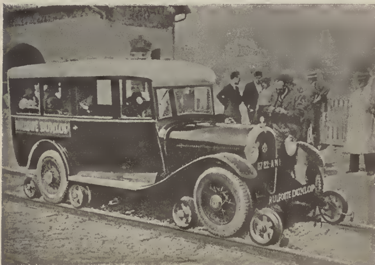
O novo auto-carro «Dunlop» que pode circular sôbre estrada ou sôbre carril
