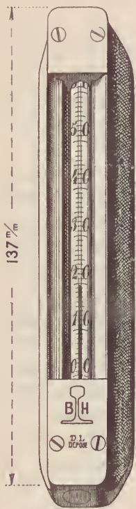
Termómetro usado pelo pessoal da via, em caminhos de ferro
